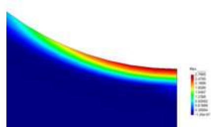
图 10 第 16 步最小主应力
