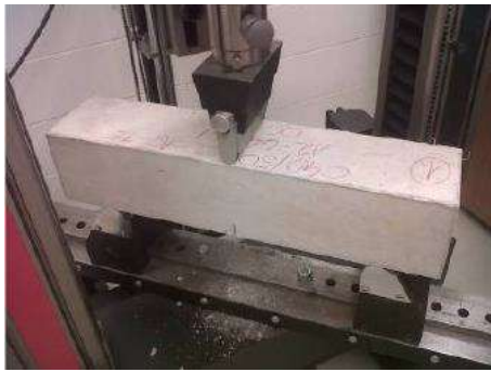
图2 梁受弯试验图
